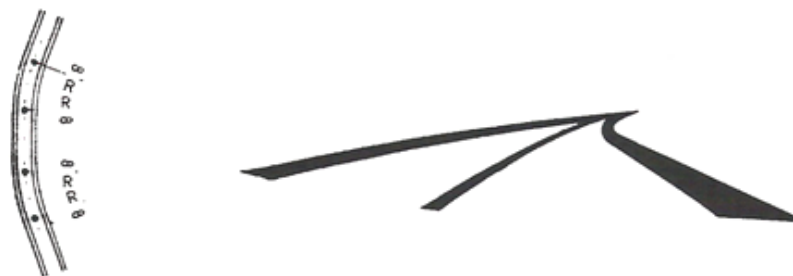
figura 1.104. Mau traçado em planta (pequeno alinhamento entre duas curvas com o mesmo sentido)
