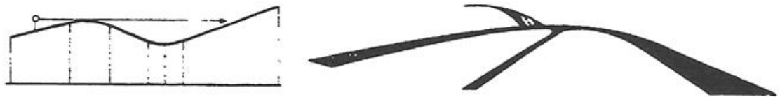
figura 1.106. Mau traçado em perfil (perda do traçado)
