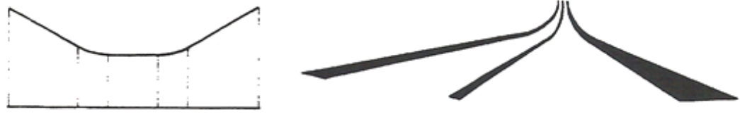
figura 1.105. Mau traçado em perfil (pequeno tranelo entre duas concordâncias côncavas)
