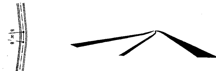
figura 1.102. Mau traçado em planta (raio diminuto)
