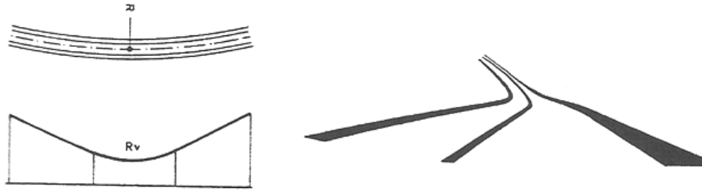
figura 1.109. Curva circular de grande raio e concordância côncava de pequeno raio, provocando quebra do traçado em planta
