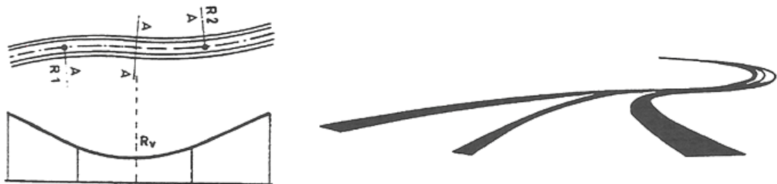
figura 1.111. Concordância côncava entre duas curvas circulares provocando quebra e estreitamento óptico da estrada
