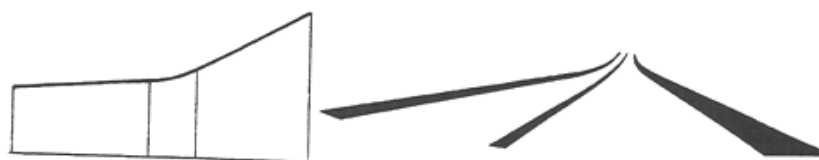
figura 1.103. Mau traçado em perfil (concordância diminuta)
